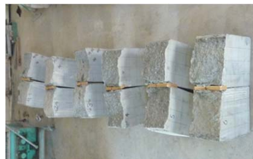
注入後の試験体 (W:400 × D:600 × H:1200)
