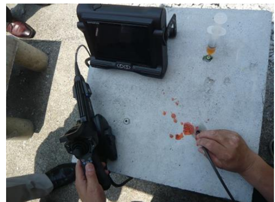
写真4 工業用内視鏡の調査状況
