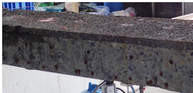
写真7 使用した撤去床版
