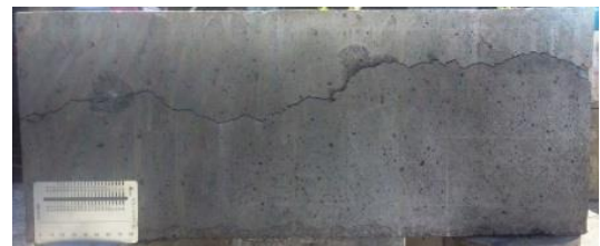
写真3 水平ひび割れを有する試験体
